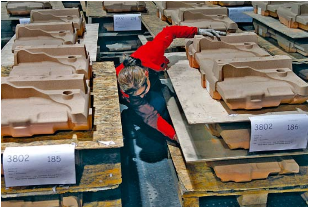
Valmiit biekasta valmistetut keurnat asetetaan yleensä käsin muotteihin. Sideaineena käytetään bentoniittia ja vettä.
